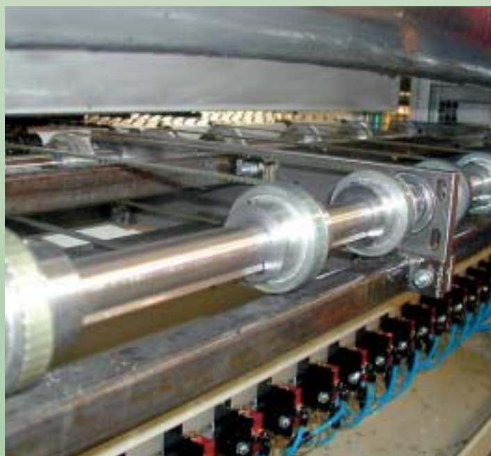
Convoyeur de flans métalliques avec huilage par micro lubrification pour alimentation de presse automatique de 1.000 tonnes.
