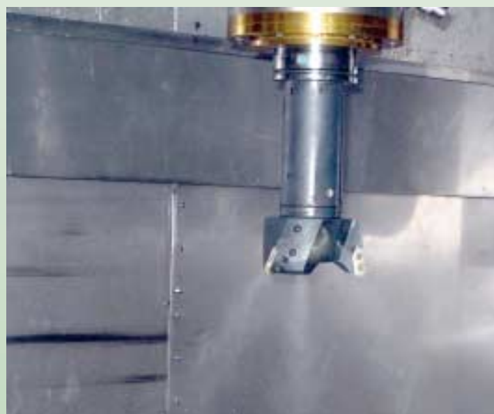
Micro-pulvérisation pour usinage à haute vitesse.
