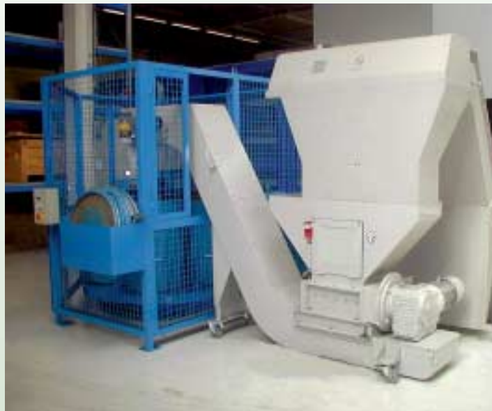
Transport, traitement et stockage de copeaux alu.
